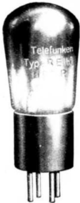
Verwendungszweck: Schwingröhre für Überlagerer und Zwischenfrequenz-(Superheterodyn-)Empfänger. Hochfrequenz- und Audionröhre für Mehrrohrempfänger, wo besonders große Leistung oder hohe Lebensdauer erwünscht ist.
